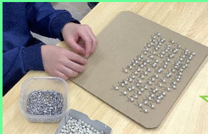
ジョブライフ万葉 部品の塗装前処理
